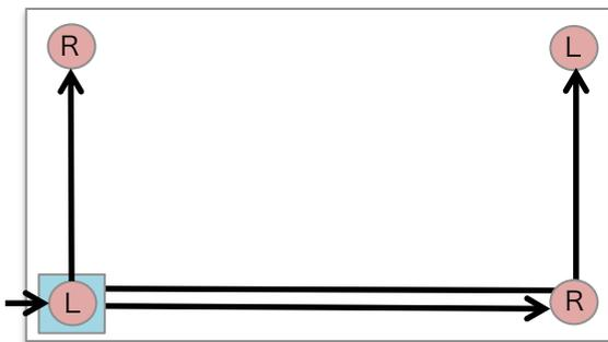
4スピーカーの場合は2つのアンプを使用しますが、それぞれのスピーカーの配置を確認の上、スピーカーと接続したオーディオケーブルが、オーディオアンプのRとLに交互に接続されるようにしてください。
