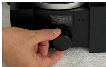
オーディオアンプの前面にある丸いツマミ（音量ツマミ）を動かし、音量が0になっていないことを確認してください。
