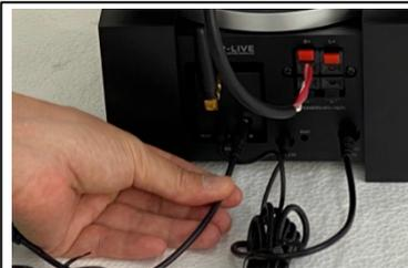
ワイヤレスレシーバにささっているACアダプタを抜き差ししてください。（ピーポパンポン→ピンポンと3段階に音がることを確認してください）
