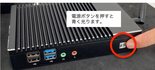
(G)R-LIVE専用PCのACアダプタを接続した上で、電源ボタンを押してください。ボタン部分が青く光り、起動を始めます。
