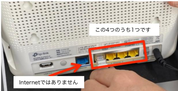
(H)Wi-Fiルータの背面の1-4のいずれか（Internetではないのでご注意ください）の挿し口に(I)LANケーブルの一端を挿し、もう一端を(G)R-LIVE専用PCの挿し口に挿し、有線でつなぎます。
