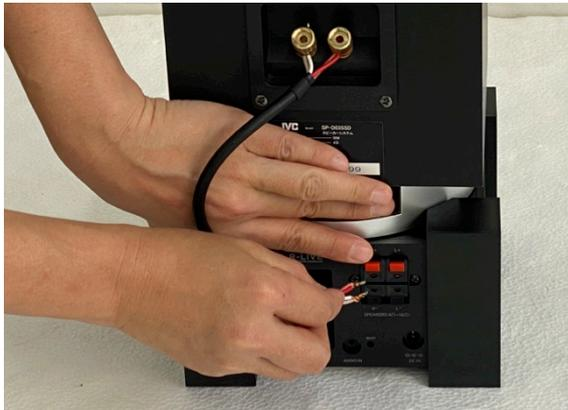
(D)スピーカーケーブルの另一端は、(B)オーディオアンプ背面のLまたはR※いずれかの赤色の爪に(C)スピーカーケーブルの赤の先端を、黒い爪には白の先端を挿しこみ固定してください。
