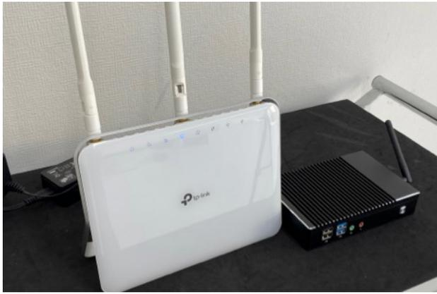
まず最初に、各スピーカーからおおよそ10m以内の出来るだけ腰よりも高い位置に（電波が届きやすくするため）、(H)Wi-Fiルータを配置します。アンテナの取り付けが必要なタイプの(H)Wi-Fiルータの場合（左の写真では3本の白いもの）、ねじ込んで取り付けてください。
